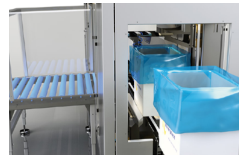
① Posizionamento della scatola
