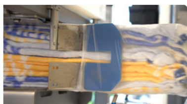
4 Spinta della pila di biancheria nella busta
